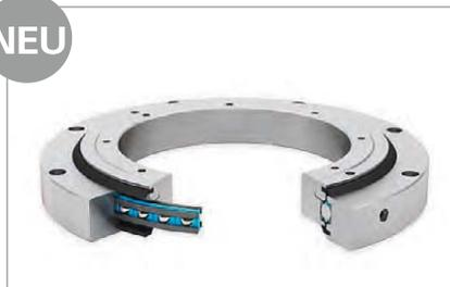
Franke Drehverbindungen sind einbaufertige Komplettlager mit integriertem Drahtwälzlager. Ausgelegt als 4-Punkt-Lager nehmen sie gleich hohe Belastungen aus allen Richtungen auf und sind unempfindlich gegenüber Stößen und Vibrationen. Die Drehverbindungen sind beidseitig abgedichtet und spielfrei mit Vorspannung eingestellt. Auf Wunsch erhalten Sie die Drehverbindungen ab Werk mit den von Ihnen gewünschten Vorspannungswerten.
