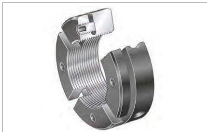
Präzisions-Nutmuttern werden verwendet, wenn hohe Axialkräfte übertragen werden müssen und eine hohe Planlaufgenauigkeit und Steifigkeit verlangt wird. Das Gewinde und die am Wälzlager anliegende Planfläche der Nutmutter sind in einer Aufspannung gefertigt. Dadurch wird eine sehr gute Planlaufgenauigkeit erreicht. Die Nutmuttern gibt es in den Ausführungen AM, ZM und ZMA. Sie sind bei fachgerechter Handhabung mehrfach verwendbar.
