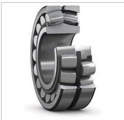
Pendelrollenlager haben zwei Rollenreihen mit einer gemeinsamen hohlkugeligen Laufbahn im Außenring und zwei zur Lagerachse geneigte Laufbahnen auf dem Innenring. Der Mittelpunkt der hohlkugeligen Laufbahn im Außenring liegt mittig auf der Lagerachse.
