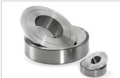
Axial-Gelenklager haben ebenso wie Schräg-Gelenklager schräg zur Lagerachse angeordnete Gleitflächen an der Gehäuse- und an der Wellenscheibe. Sie eignen sich jedoch in erster Linie für die Aufnahme von axialen Belastungen, können aber auch kombiniert belastet werden. Dabei darf allerdings die Radialbelastung nicht größer sein als 50 % der gleichzeitig wirkenden Axialbelastung.
