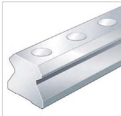
Die Führungsschienen sind aus gehärtetem Stahl und allseitig geschliffen, die Laufbahnen für die Wälzkörper feinstgeschliffen. Führungsschienen TSX..-E (-ADB, -ADB+K) sind von oben, Führungsschienen TSX..-E-U von unten zu befestigen.
