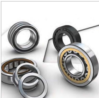
Zylinderrollenlager werden in vielen Bauformen, Maßreihen und Größen gefertigt. Während die Lager mit Käfig auch bei hohen Belastungen noch hohe Drehzahlen und hohe Beschleunigungen zulassen, sind die vollrolligen Lager aufgrund der vielen Rollen für langsam umlaufende, sehr hoch belastete Lagerungen geeignet. Bei Hochleistungs-Zylinderrollenlagern ist die hohe Tragfähigkeit der vollrolligen Lager mit den bei Lagern mit Käfig möglichen hohen Drehzahlen kombiniert.
