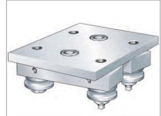
Kostengünstig und niedriges Gewicht – das sind die Merkmale des Hohlkammer-Laufwagens **LFCL**. Er läuft spielfrei auf den Tragschienen LFS. Die Parallelitätstoleranz dieser Tragschienen beträgt nur 20 µm. Deshalb benötigt der Hohlkammerlaufwagen LFCL keine exzentrischen Zapfen zur Spieleinstellung. Der Hohlkammerlaufwagen wird mit eingeschobenen Nutensteinen sowie montierten Laufrollen und Abdeckkappen geliefert. Die Zapfen sind mit dem nötigen Anziehdrehmoment angezogen.
