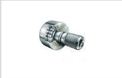
Kurvenrollen sind einbaufertige, selbsthaltende Stützrollen, die anstelle des Innenringes einen massiven Bolzen haben. Dieser ist mit einem Gewinde versehen, so dass die Kurvenrollen schnell und einfach mit Sechskantmuttern an angrenzenden Maschinenteilen befestigt werden können.
