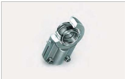
Hydraulik-Gelenkköpfe sind mit Radial-Gelenklagern GE...LO oder GE...DO ausgerüstet. Sie haben Stahl/Stahl-Gleitpaarungen, nehmen radiale Kräfte in Zug- oder Druckrichtung auf, übertragen Bewegungen und Kräfte und sind geeignet für wechselnde radiale Belastungen.
