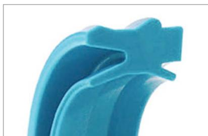
Stangendichtungsabstreifer mit integriertem Haltewulst und gutem Schutz gegen Eindringen von Schmutz. Die Auslegungen der Dichtung und der Nut sind so gewählt, dass eine einfache Montage, von Hand oder automatisch möglich ist.
