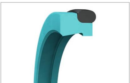
Ein Doppelabstreifer mit zwei geometrisch unterschiedlichen Abstreiflippen. Der Einbau erfolgt immer zusammen mit einem O-Ring. Der Werkstoff M12 unterstützt die Abstreifwirkung durch einen hervorragenden mechanischen Wirkungsgrad bei geringer Reibung.
