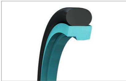
Als Sekundärdichtung wurde der Zurcon® Rimseal® entwickelt. Er gewährleistet im System ein sicheres Abdichten von dünnen Ölfilmen bei niedrigen Sekundärdrücken. Als entsprechende Primärdichtung wird der Turcon® Stepseal® 2K verwendet.
