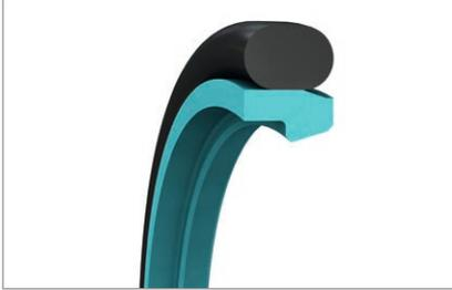
Der Stepseal® 2K ist ein einwirkendes Dichtelement, bestehend aus einem Dichtring aus hochwertigem Turcon® Werkstoff und einem O-Ring als elastisches Vorspannelement. Er hat vor allem durch den Werkstoff M12 einen hohen mechanischen Wirkungsgrad bei geringer Reibung und ist in kleinen Einbauhöhen leicht montierbar.
