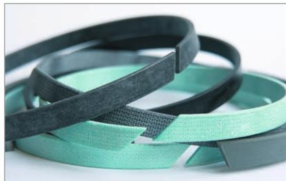
Führungsringe haben die Aufgabe, den Kolben und die Kolbenstange eines Arbeitszylinders zu führen und die auftretenden Querkräfte aufzunehmen.
