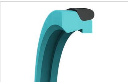
Ein Doppelabstreifer mit zwei geometrisch unterschiedlichen Abstreiflippen, die entgegengesetzt angeordnet sind. Der Abstreifer wird zusammen mit einem O-Ring als elastisches Vorspannelement in eine Nut eingebaut.
