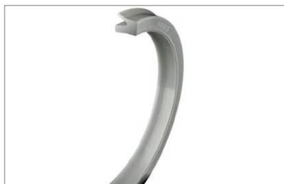
Einfachwirkende Kolbendichtung mit U-förmigem Querschnitt. Bei doppeltwirkenden Kolben werden zwei Dichtungen „Rücken an Rücken“ verwendet.
