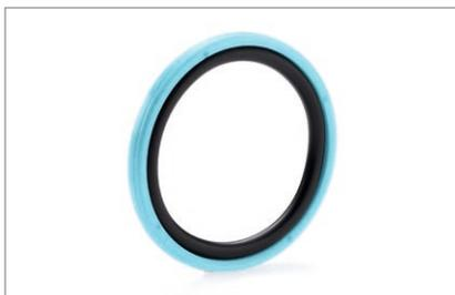
Der Roto Glyd Ring S wird zur Abdichtung von Wellen, Achsen, Gehäusen, Drehdurchführungen, Schwenkvorrichtungen u. a. bei langsamen, gleichmäßigen oder schwenkenden Bewegungen eingesetzt. Speziell für Anwendungen mit hohen Drücken und geringen Gleitgeschwindigkeiten. Die Dichtung ist doppelwirkend und zeigt eine geringere Reibung als herkömmliche PTFE-Roto-Dichtungen.
