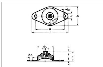
SCHWINGMETALL® Hut-Elemente zur Lagerung von Messgeräten und kleineren Aggregaten. Die Federung ist sehr weich und in allen Richtungen gleich. Hut-Elemente müssen axial belastet werden. Naturkautschuk wahlweise in 40°, 55° und 65° Shore A.
