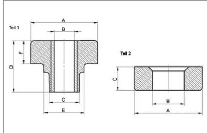
GM-Isolierhülsen wurden für Anwendungen mit schweren dynamischen Kräften sowohl in der statischen als auch Rückprallrichtung entwickelt. Bewegung in beide Richtungen wird durch die Bauart begrenzt. Die Hülse wird für Motoren, Fahrerhäuser und Nebenaggregate verwendet. Die GM-Isolierhülse isoliert Schwingungen und absorbiert Schock.
