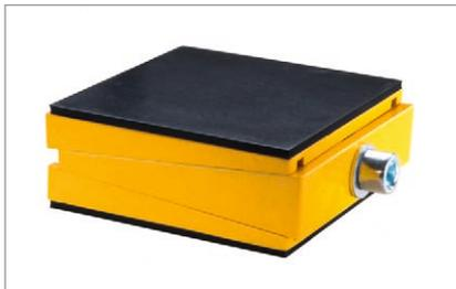
Niveaustabiler Nivellierschuh mit rutschhemmendem Belag. Die Verstellung erfolgt über einen Keil durch eine seitliche Stellschraube mit Feingewinde.
