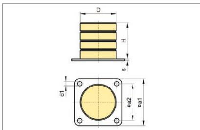
Kranpuffer mit Kunststoffplatte. Anschlagpuffer aus gemischtzelligem Polyurethan bestehen mit hervorragenden Dämpfungseigenschaften bei minimaler Querdehnung und sind somit ideal als Pufferelemente geeignet.
