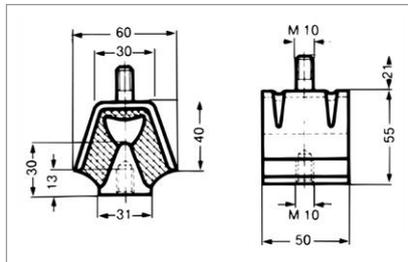
SCHWINGMETALL® Dach-Elemente sind vielfach einsetzbare Aggregatlager. Im Allgemeinen werden sie so eingesetzt, dass die statische Last in Z-Richtung wirkt. Es gibt Dach-Elemente mit Abreißsicherung.
