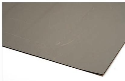
Einseitig selbstklebende, flexible, polymermodifizierte Bitumenfolien. Oberseite beschichtet mit einer PE Antiblocksicht. Geeignet zur Dämpfung von Körperschallabstrahlung (Entdröhnung) bei Metall-/Blechkonstruktionen aus Alu, Stahl, Kupfer oder auch harten Kunststoffen sowie zur Luftschalldämmung von Leichtbauelementen aus Holzwerkstoffen, Gipskarton oder Metallblechen.
