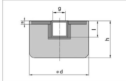
Speziell als Anschlag- oder Anfahrschutz bei Kranen konzipierte Puffer mit unterschiedlichen Möglichkeiten der Befestigung.
