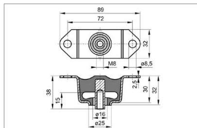
Deckenelemente sind reine Hängeelemente und eignen sich besonders für die elastische Aufhängung von Beleuchtungskörpern, Apparaten und Rohrleitungen an Decken. Eine Abreißsicherung ist eingebaut.
