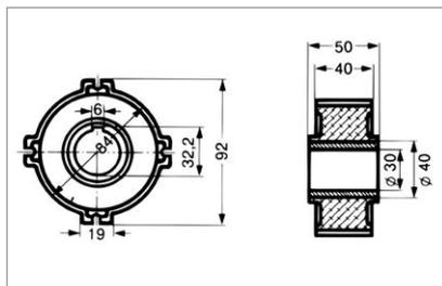
SCHWINGMETALL® Torsionsbuchsen eignen sich zur weichen Axialfederung bei guter Radialführung und für torsionselastische Gelenke. Naturkautschuk wahlweise in 40°, 55° und 65° Shore A.
