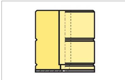
Sicherheitspuffer für den Aufzugbau. Überall dort, wo ungefederte Massen aufeinander prallen können, müssen die auftretenden Kräfte zuverlässig begrenzt werden. Dafür eignen sich in hervorragender Weise die leistungsstarken Aufsetzpuffer aus unserem Hochleistungs-Polyurethan. Sie überzeugen durch Hydrolysefestigkeit, ein optimiertes Dämpfungsvermögen, große Lastbereiche und höhere Arbeitsaufnahmen.
