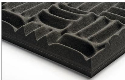
Pinta Wffel B3 ist ein faserfreier Schaumstoff auf PU-Basis und erfüllt die Baustoffklasse B3 nach DIN 4102. Durch die waffelförmige Struktur wird die Oberfläche vergrößert, und es werden gute Schallabsorptionswerte im mittleren bis hohen Frequenzbereich erzielt.
