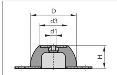
Die Hutelemente sind sowohl in radialer als auch in axialer Richtung hochelastisch und bieten somit eine hervorragende Stoßisolierung.
