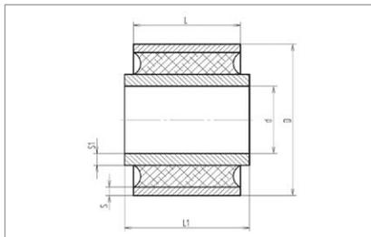
Gummielastische Lagerungen, vorwiegend für den Einsatz im Fahrzeug- und Maschinenbau.
