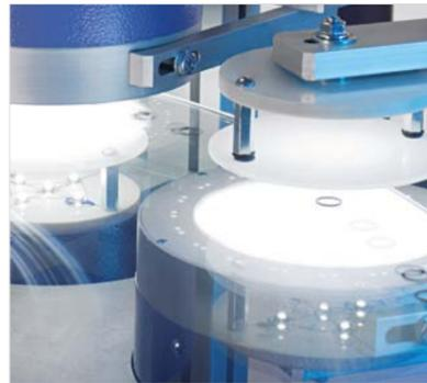
Visuelle Prüfung von Abmessungen und Oberflächen
