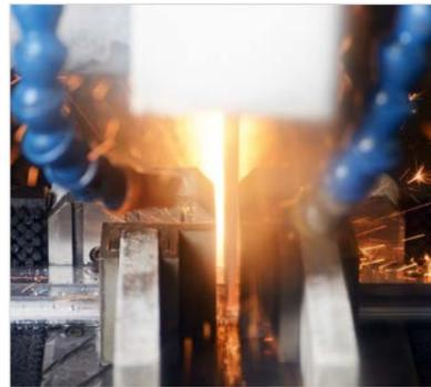
Konfektionieren von Wellen und Schienen
