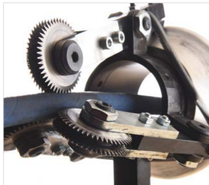
Pricken der Schlauchdecke
