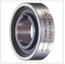
Diese Ausführungen sind konzipiert für leichte und mittlere Anwendungsfälle. Sie können ebenso für Mehrfach-Einbauten eingesetzt werden. Die Abmessungen der TSS-Ausführung entsprechen der Kugellagerbaureihe Nr. 62, die TFS-Ausführung entspricht den Abmessungen der Kugellagerbaureihe Nr. 63.
